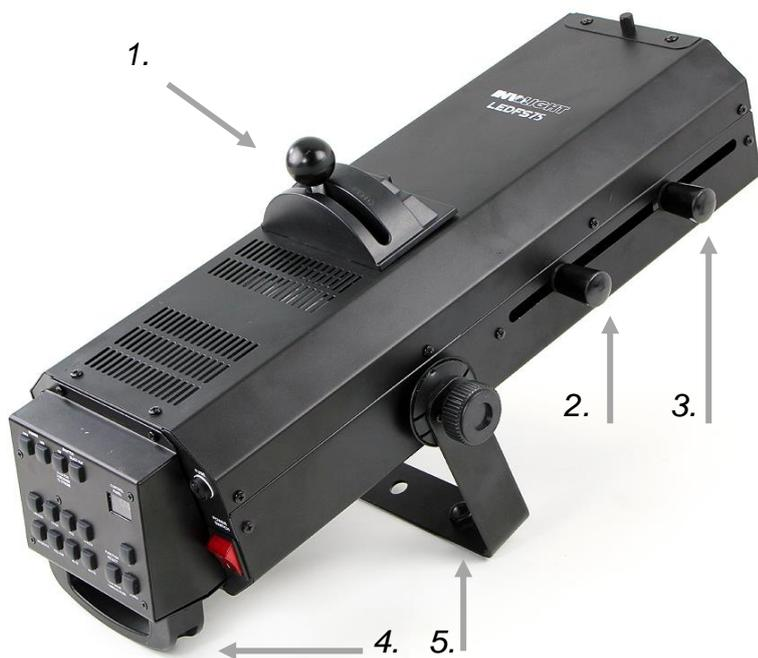
**1. Hebel zur Verstellung der Irisblende.** Mit der Irisblende kann der Lichtkreisdurchmesser eingestellt werden vom kleinsten „spot“ bis zum vollen „flood“, wobei die Beleuchtungsstärke sich nicht verändert.
