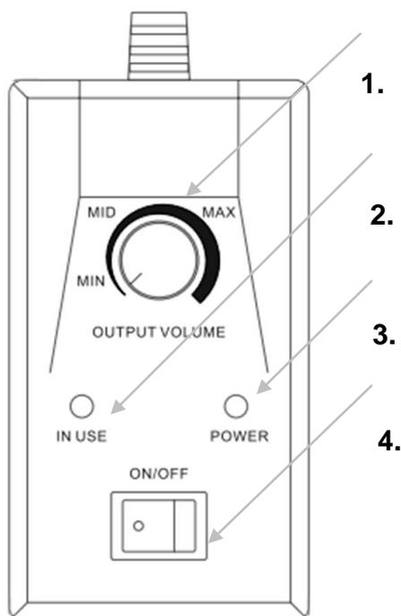
Подключите кабель дистанционного управления в 5-контактный разъем на задней панели прибора (См. п. 4.1 задней части корпуса). Включите генератор снега нажав на кнопку Power (См. пункт 4.1 задней части корпуса). Загорается красный светодиод (3). Включите пульт дистанционного управления с помощью переключателя (4). Загорается зеленый светодиод. Пульт дистанционного управления готов к работе. С помощью регулятора (1) можно настроить количество выброса снега. (слева направо (1% - 100%))
