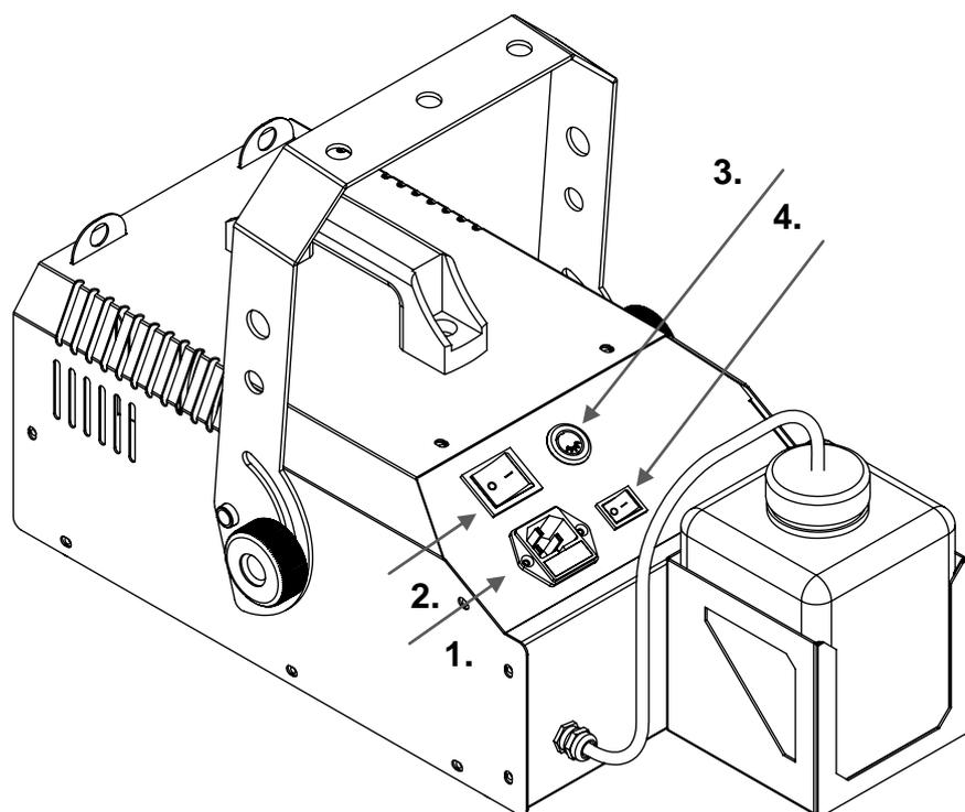
**1. POWER IN:** IEC входной разъем питания переменного тока с держателем предохранителя F6 3A 250V.
