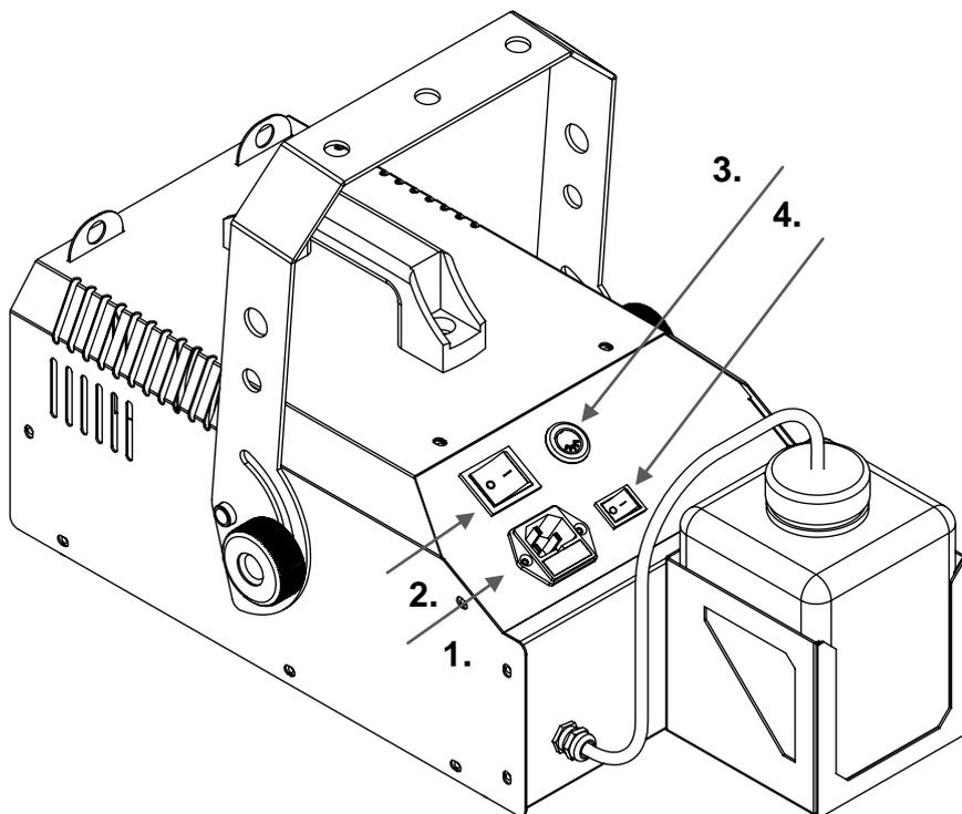
**1. POWER:** IEC Netzstromeingang Buchse mit Sicherungshalter für F6,3A 250V Sicherung.
