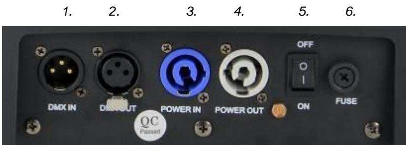
1. 3-polige XLR-Eingangsbuchse zum Anschließen eines DMX-Kontrollgerätes (z.B. DMX-Mischpult)
