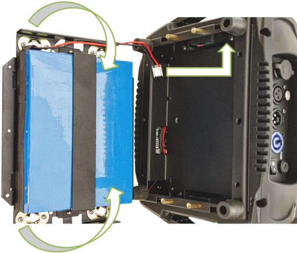
3. Platzieren Sie den Akku so im geöffneten Fach, dass sich das Anschlusskabel unter der inneren Gehäuseöffnung befindet.
