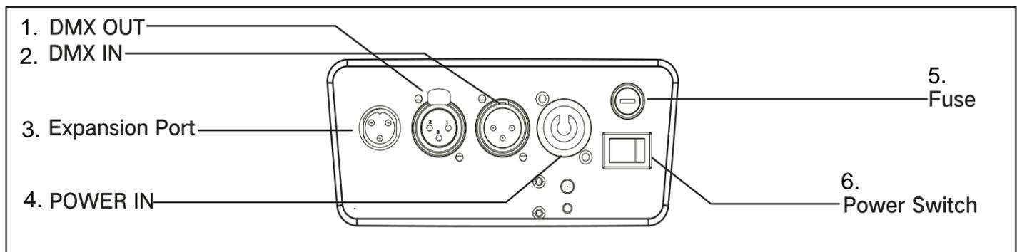
1. 3-polige XLR-Ausgangsbuchse zum Weiterleiten des DMX-Steuersignals.
