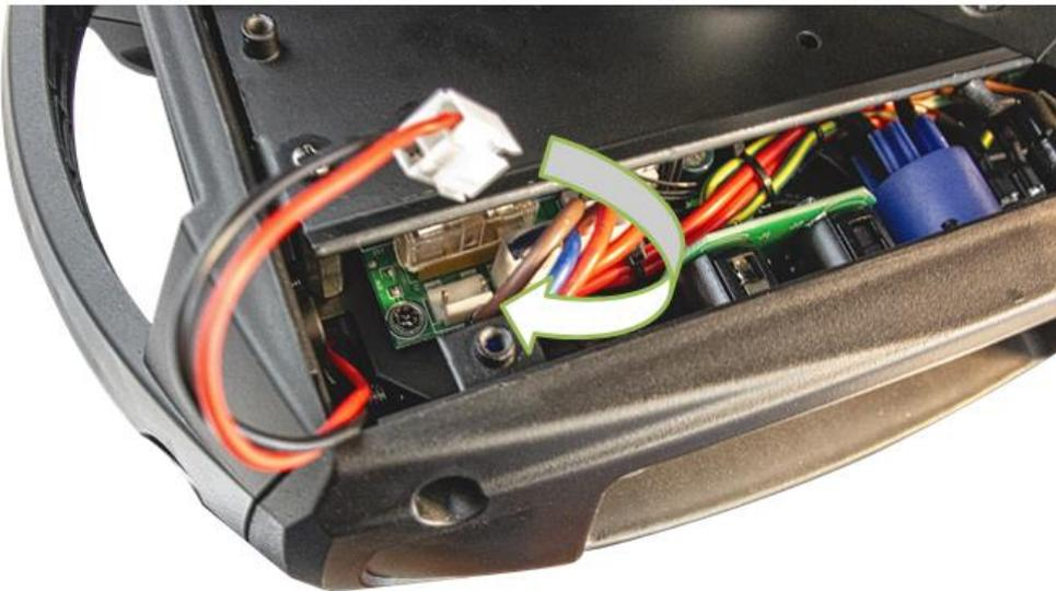
4. Fädeln Sie das Anschlusskabel durch die innere Geräteöffnung und schließen Sie die Kabelbuchse an den abgebildeten Gerätestecker an. Achten Sie auf die richtige Ausrichtung der Buchse!
