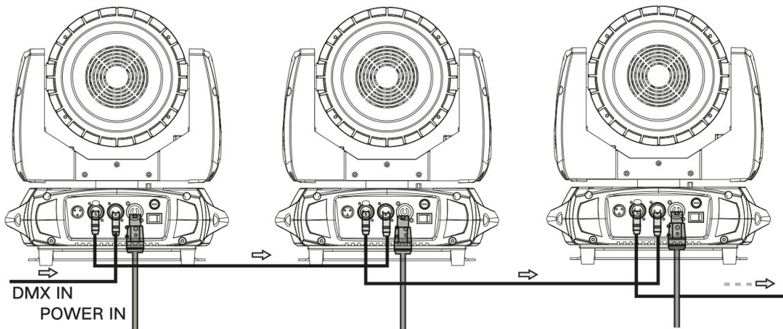
Für Anlagen mit sehr langen DMX-Kabelwegen oder hohen elektrischen Störeinflüssen, wie zum Beispiel in einer Diskothek, ist es empfehlenswert, einen DMX-Terminator zu verwenden. Der DMX-Abschlusswiderstand wird in einem XLR-Stecker als 120  $\Omega$  Widerstand zwischen Pin 2 und 3 ausgeführt der in die letzte Ausgangsbuchse der DMX-Linie gesteckt wird.
