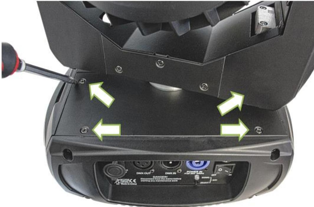
1. Lösen Sie die 4 markierten Schrauben, um an den Anschluss für den internen Akku zu gelangen. Dieser befindet sich von oben betrachtet in der linken, unteren Ecke.
