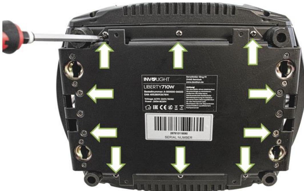
2. Lösen Sie die 10 markierten Schrauben, um das Fach für den internen Akku zu öffnen.
