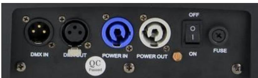
1. 3-polige XLR-Eingangsbuchse zum Anschließen eines DMX-Kontrollgerätes (z.B. DMX-Mischpult)
